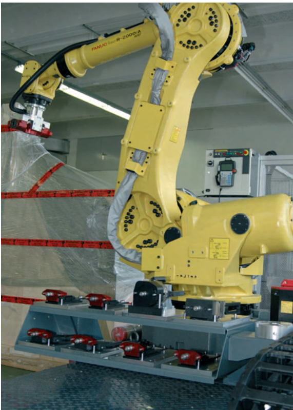
Bis zu zwölf Maschinen versorgt der auf einer 17 m langen Ver-fahrachse laufende Fanuc-Roboter. (Bilder: FANUC Robotics/Robotec)
