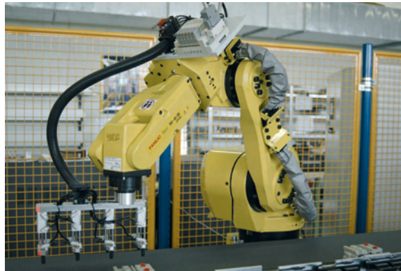
Bis zu 125 Zyklen pro Minute schafft der Highspeed-Roboter M-6iB/zHS, wobei die Dual Arm-Konfiguration noch höhere Leistungen ermöglicht.
