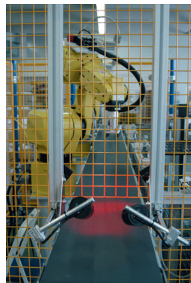
Der Einsatz des Fanuc-eigenen Vision-systems V-500i spart aufwändige Positioniermassnahmen für die Teile.
